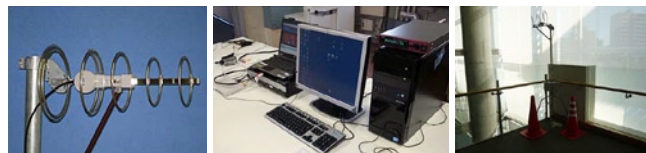
写真1～3 使用機材；<左>送信空中線アンテナ10mW、<中>送出装置（上部；OFDM変調器、本体；番組送出装置、ビデオエンコーダ、多重化装置、データ放送送出装置）、<右>中継送信基地）
