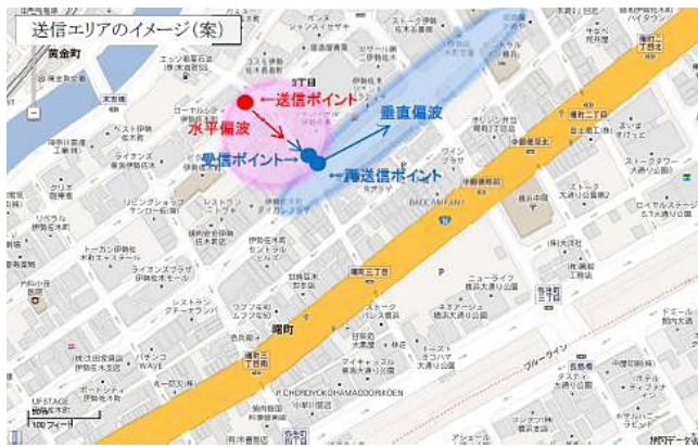
図3 電波中継によるエリア拡張図
