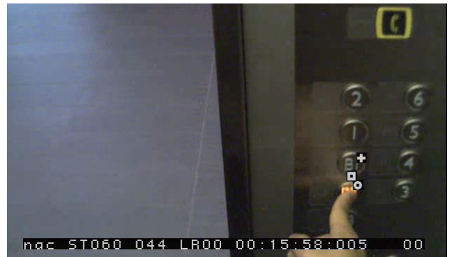
Fig. 9 Eye movement when searching for the switches of the elevator エレベーターのスイッチを見ているときの視線（+：左目、□：右目、○：視差補正した視線）
