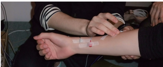
Fig. 10 Measurement of an electromyogram (EMG) 筋電用電極を装着している様子
